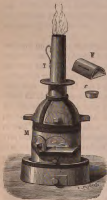
Fig. 257. — Fourneau à coupellation. Le four O est ouvert; on en voit le détail en F; en c est une coupelle séparée.
